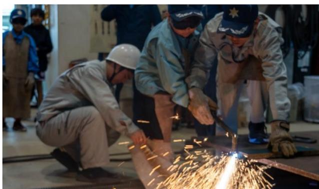
電気と空気力で鉄を溶断します
